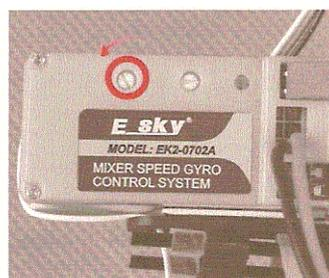
**2b-** Durant le vol, si la queue devient parfois incontrôlable et oscille largement de gauche à droite cela indique que le gyroscope la stabilise trop tard. Ajustez le potentiomètre nommé 'gain' en le tournant vers la droite, dans le sens des aiguilles d'une montre, de façon à augmenter le gain du gyroscope, comme illustré ci-dessous.
